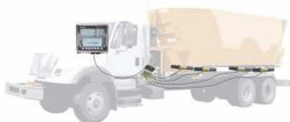
Sistemas de pesagem eletrônicos para máquinas agrícolas
