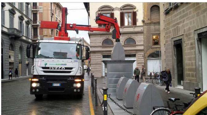
Com mais de 25 anos de experiência na área de projeto e produção de equipamentos para coleta automática, a Nord Engineering desenvolveu o **SISTEMA EASY**, um equipamento automático mono-operador bilateral capaz de coletar diferentes tipos de resíduos urbanos, seja na superfície ou subterrâneo, com baixo impacto ambiental, realizado de modo totalmente automático. O
